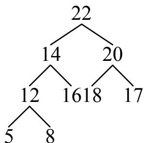
由最後一個內部節點 12 開始重建 min heap
