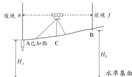
設：測站  $C$  與觀測點  $A, B$  二點的水平距離為  $\overline{AC}$ 、 $\overline{BC}$ ；觀測  $A, B$  二點的讀數為  $b, f$ 。如考慮兩差，則  $A, B$  二點高程差  $\Delta h_{AB}$
